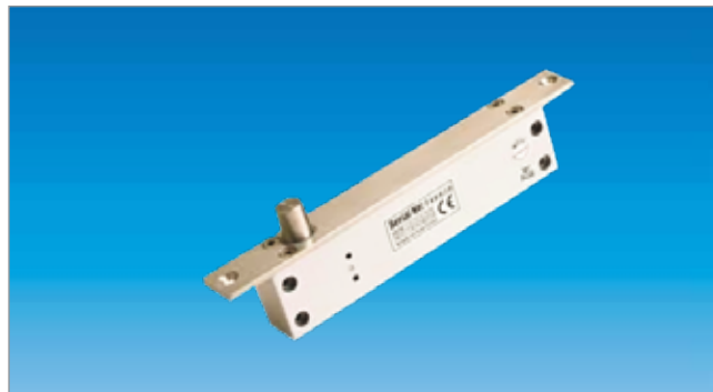
cod. 500227 Catenaccio fuori senza corrente. Dimensioni piastra: 192 x 25 x 3 mm Dimensioni corpo: 148 x 24 x 34 mm
